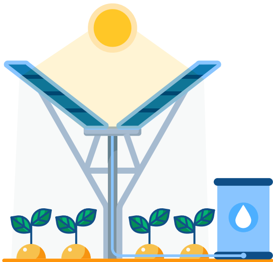
Gambar 30. Skema sistem agrivoltaic dengan tiga manfaat penggunaan lahan (pembangkit listrik, produksi pangan, dan pemanenan air hujan) (Sumber: Fraunhofer ISE, n.d.)
